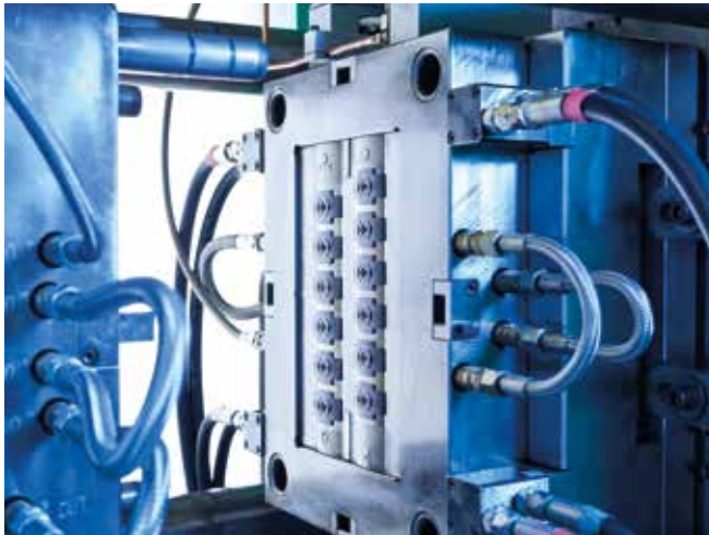
Heißkanal-Spritzwerkzeug mit 12 Kavitäten, mit 500.000 Schuß garantierter Ausbringung
